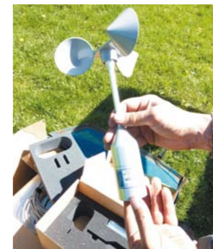
Anémomètre à coupelle (avant son installation sur le mât)
